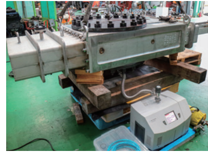
Helium Leak Test (VDI 2440)
